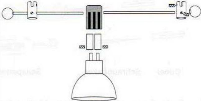
Der Stabspot ist die einfache Art LED oder Halogen Leuchtmittel quer zum Seilsystem anzubringen. Einfachste Montage durch Anschrauben. 360° drehbar Lieferung ohne Leuchtmittel.
