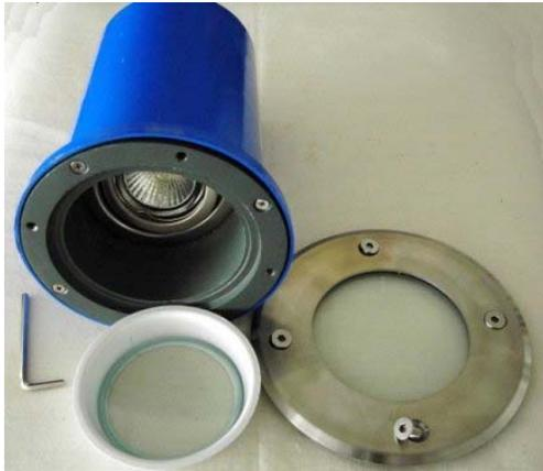
Schwenkbarer Bodeneinbaustrahler zum effektvollen Beleuchten. Lieferung inkl. Leuchtmittel 35 Watt GU10 für 230V/50Hz~. Für Aussen nach IP67 aus ALU-Druckguß. Aussen Ø: 160mm/Einbautiefe: 188mm
