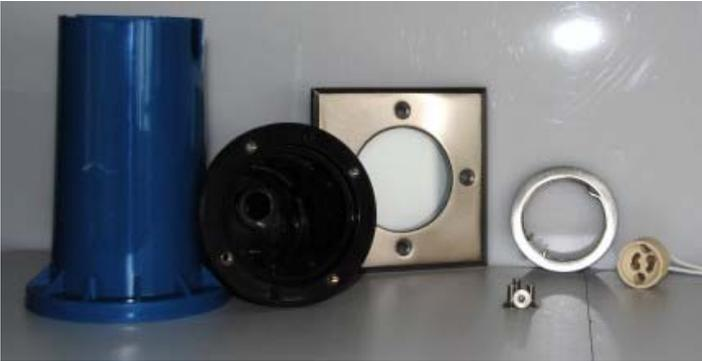
Hochvolt Bodeneinbauleuchte mit GU10 Fassung und energiesparende 60er LED Leuchtmittel. Produziert für den Aussen und Innen Bereich nach IP67 mit Material Kunststoff und Edelstahl Abdeckung. Belastbar bis 10kN. Lieferung incl. Leuchtmittel. Einbautiefe 150mm EinbauØ 100mm Abdeckung 110x110mm
