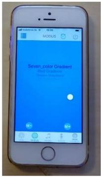
Hier hat man eine Anzeige welches der 20 Programme läuft. Darunter den Geschwindigkeit-Schiebe-Regler mit der Anzeige in Prozent. Des weiteren zwei kleine Kreise mit M- und M+ bezeichnet. Damit schaltet man zwischen den 20 Programmen hin und her. In der Mitte wird eine Anzeige des aktuellen Programms angezeigt, welches gerade läuft.
